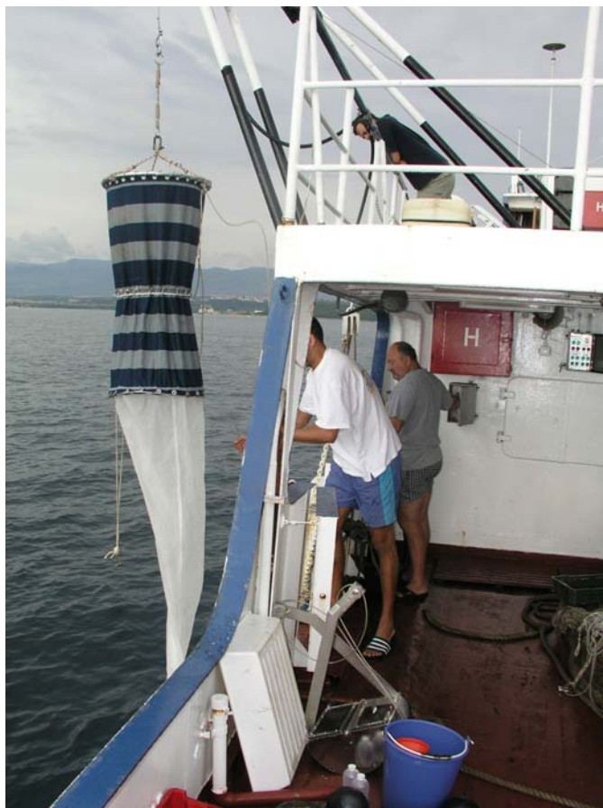
Slika 17. Uzorkovanje zooplanktona Nansen-ovom planktonskom mrežom s mehanizmom za zatvaranje (Foto: V. Tičina).
