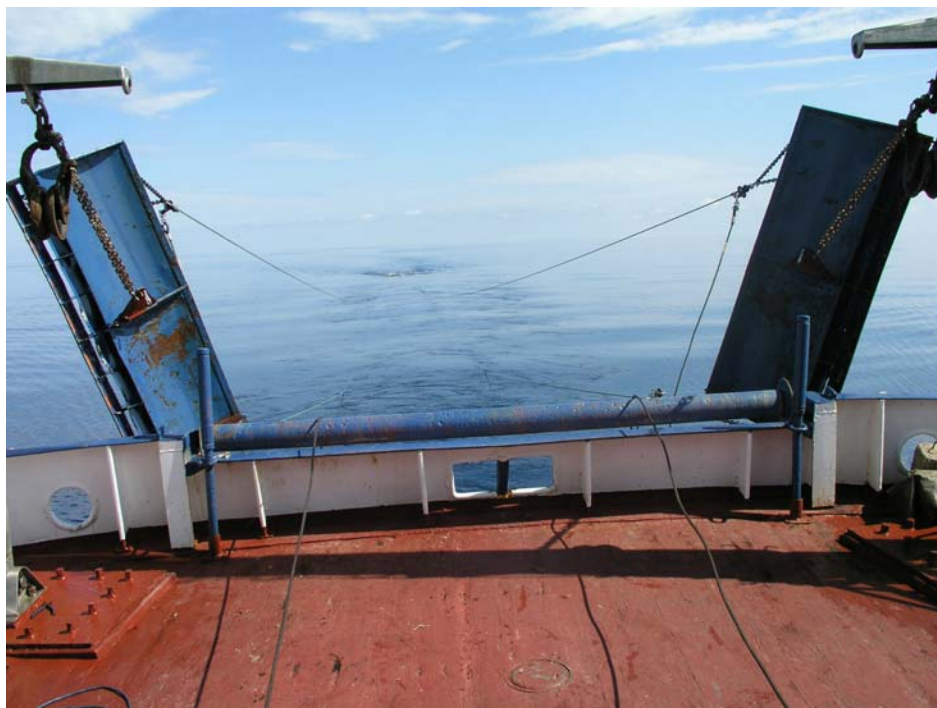
Slika 25. Pelagične širilice upotrebljavane za uzorkovanje pelagičkom koćom (Foto: V.Tičina).
