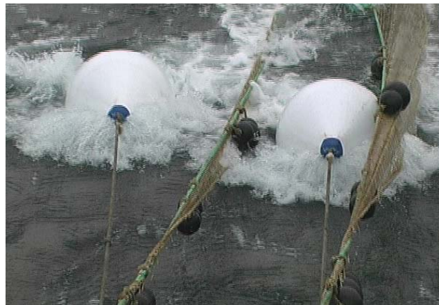
Slika 23. Baloni velikog volumena prikačeni na početku gornjih uzda (Foto: A. Soldo).
