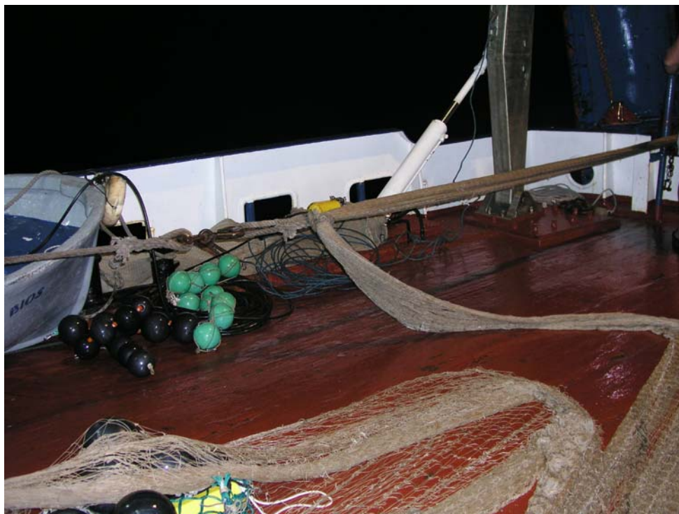
Slika 29. Izvlačenje mreže na krmenom radnom dijelu palube pomoću petlje od konopa, tzv. «imbragavanjem» (Foto: V.Tičina).
