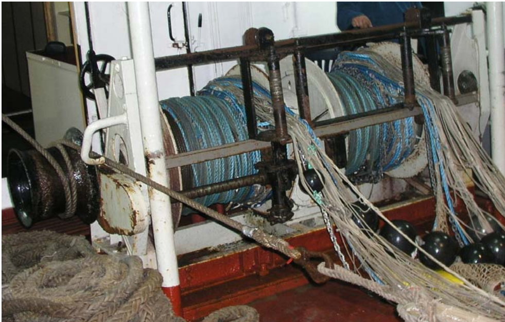
Slika 22. Koćarsko vitlo s dva glavna bubnja za povlačnu užad i dva pomoćna pritezna bubnja na MB "Bios" (Foto: V.Tičina).
