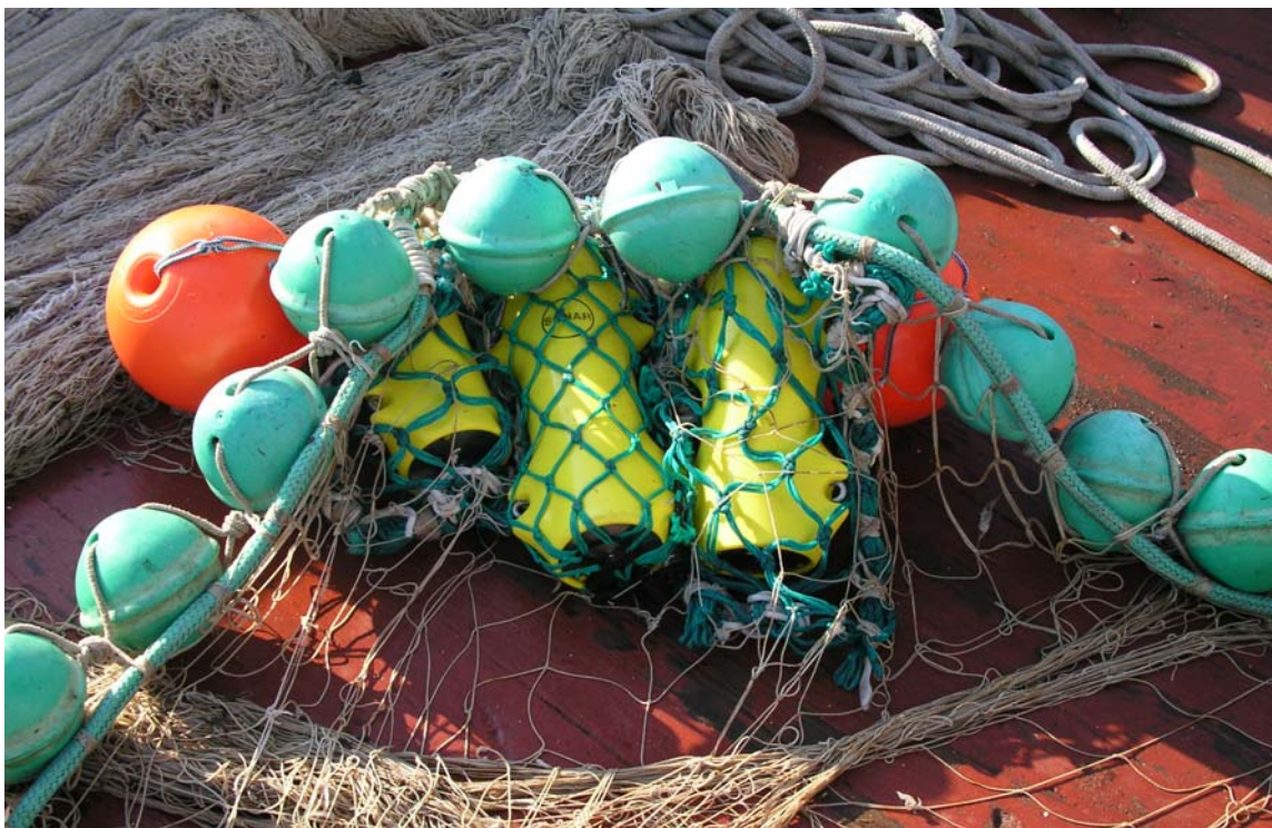
Slika 20. Mrežne sonde (žuto) montirane na plutnji pelagične koće (Foto: V. Tičina).
