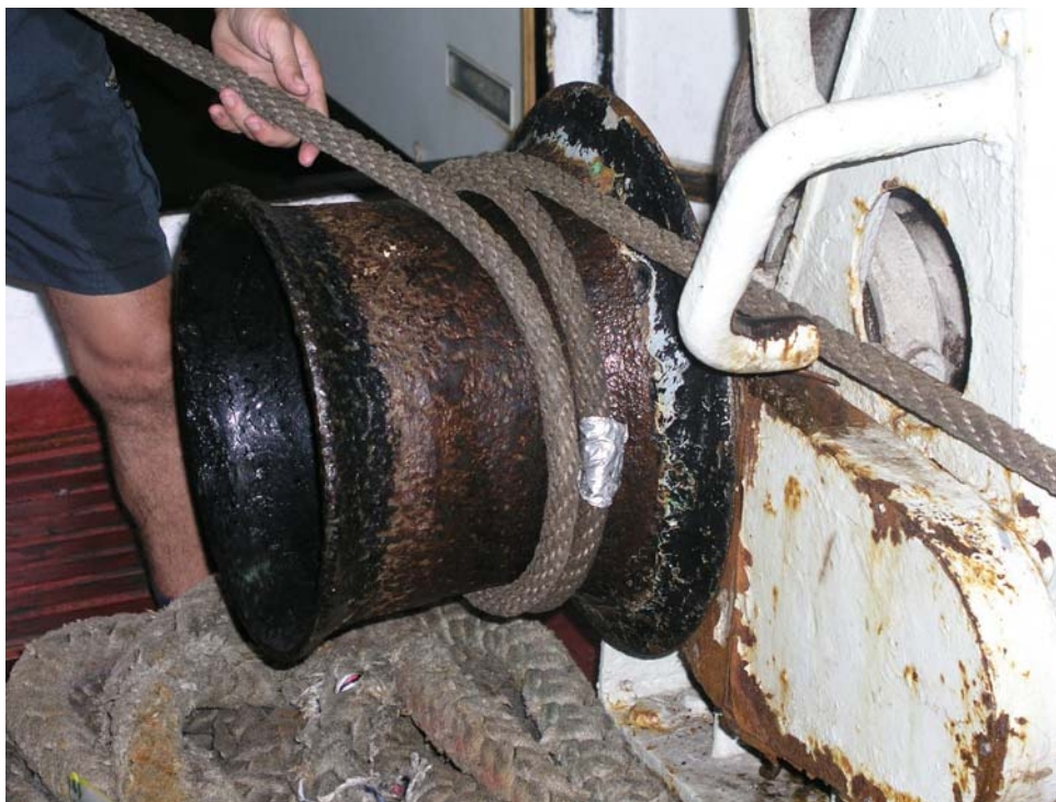
Slika 28. Izvlačenje mreže iz mora pomoću priteznog bubnja (Foto: V.Tičina).
