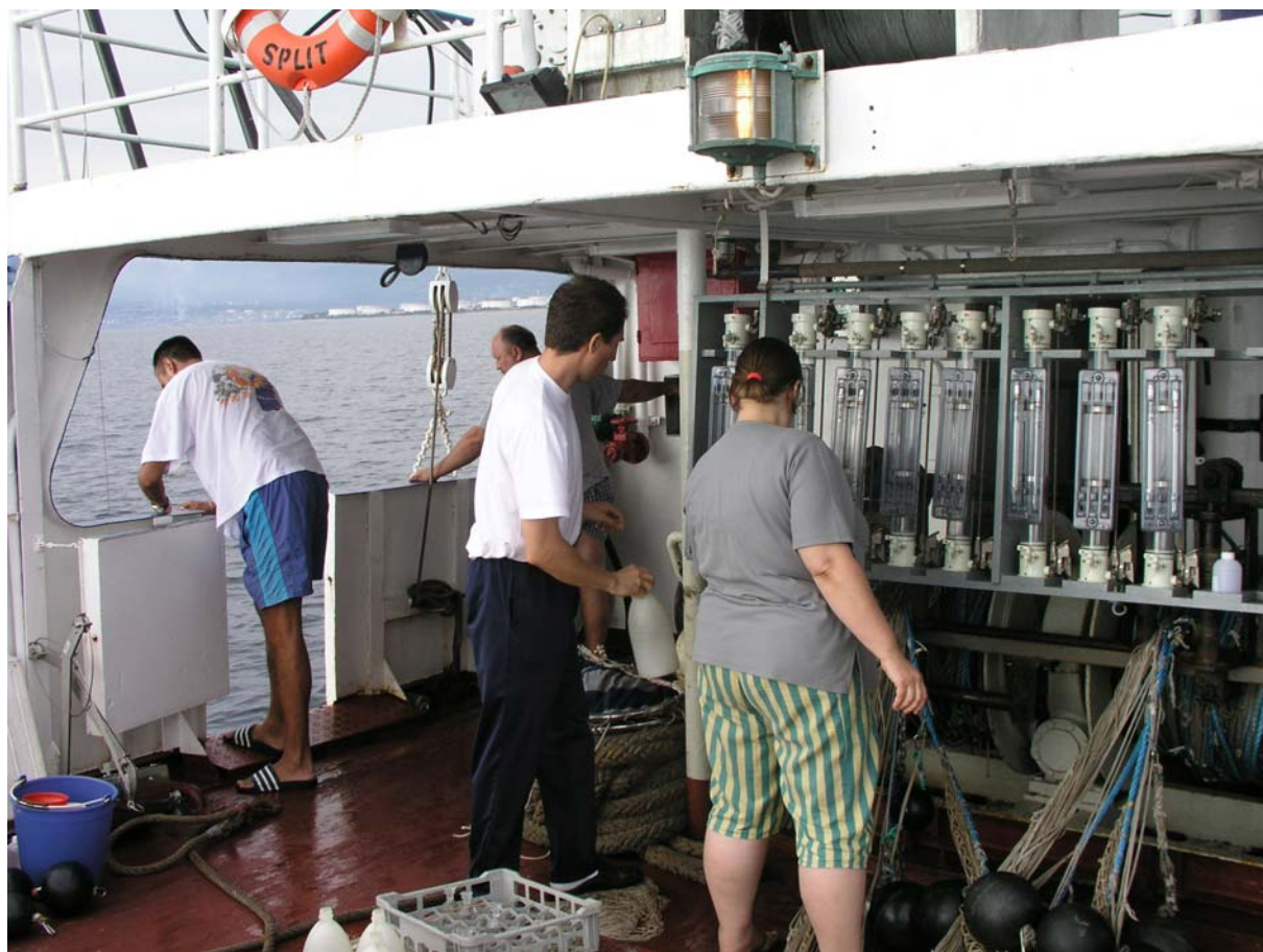
Slika 15. Uzimanje uzoraka morske vode iz Nansenovih crpaca za analizu koncentracije otopljenog kisika i fitoplanktona (Foto: V. Tičina).
