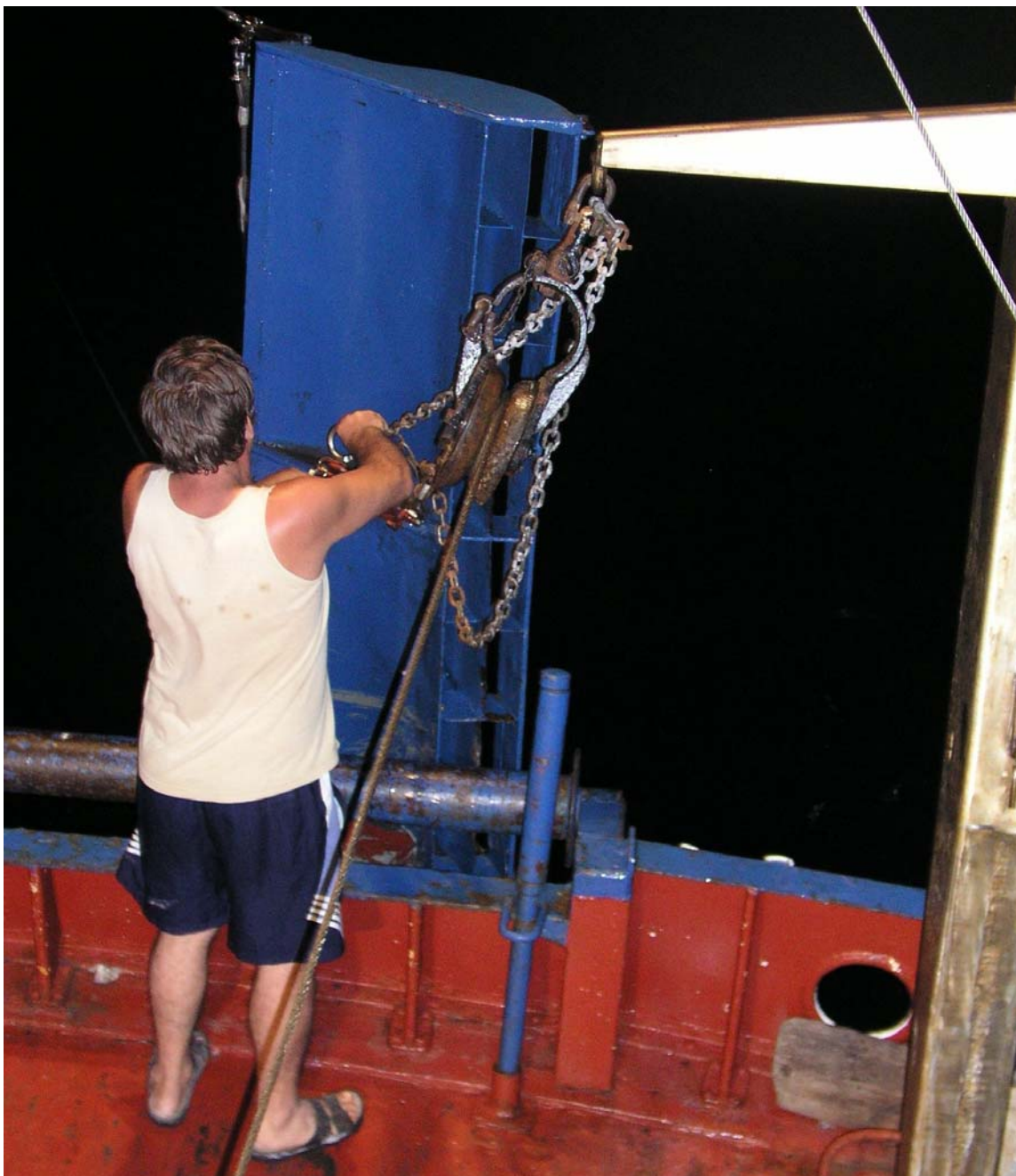
Slika 27. Učvršćivanje pelagične širilice lancem na krmeni portal (Foto: V. Tičina).
