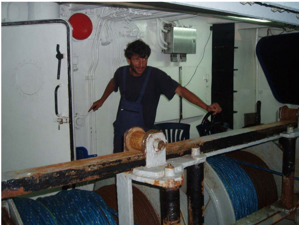
Slika 23. Kočarsko vitlo s dva glavna bubnja za povlačnu užad na MB "Bios" (Foto: D. Bogner).
