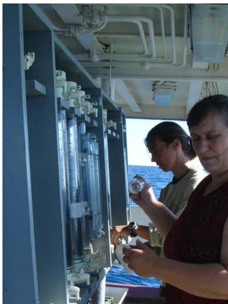
Slika 16. Uzimanje uzoraka morske vode iz Nansenovih crpaca za analizu koncentracije otopljenog kisika i fitoplanktona (Foto: V. Tičina).
