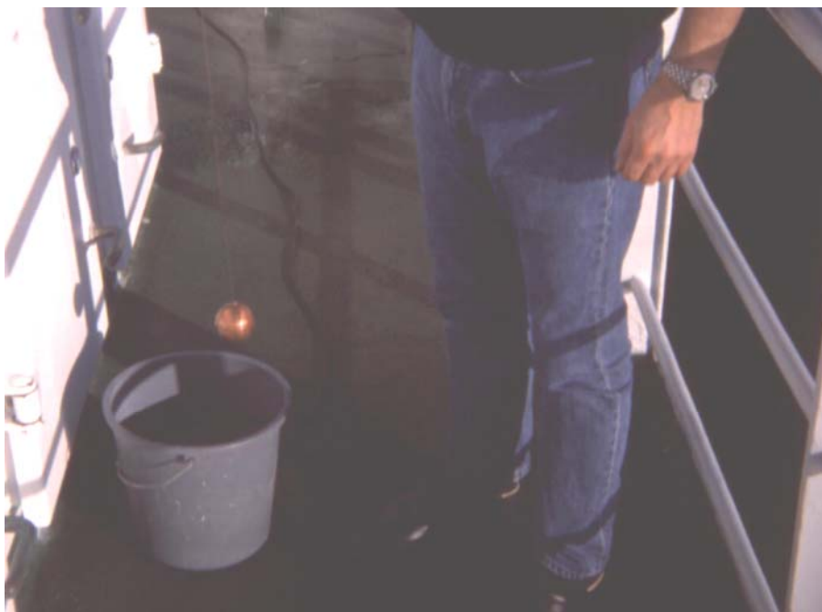
Slika 11. Namakanje bakrene kugle u blagoj otopini deterdženta neposredno prije kalibracije (Foto: V. Tičina).
