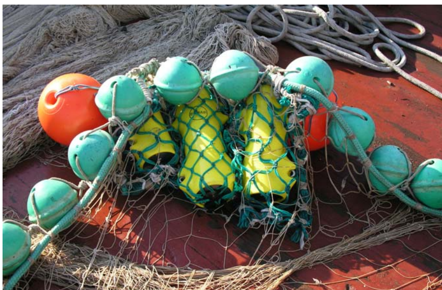
Slika 21. Mrežne sonde (žuto) montirane na plutnji pelagične koč (Foto: V. Tičina).
