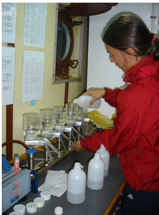
Slika 17. Filtriranje poduzoraka morske vode za analizu klorofila a (Foto: D. Bogner).
