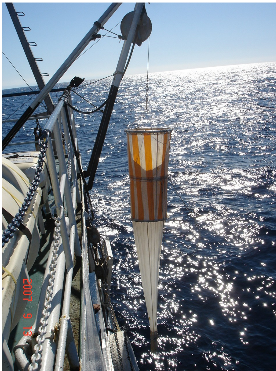
Slika 18. Uzorkovanje zooplanktona Nansen-ovom planktonskom mrežom s mehanizmom za zatvaranje (Foto: D. Bogner)
