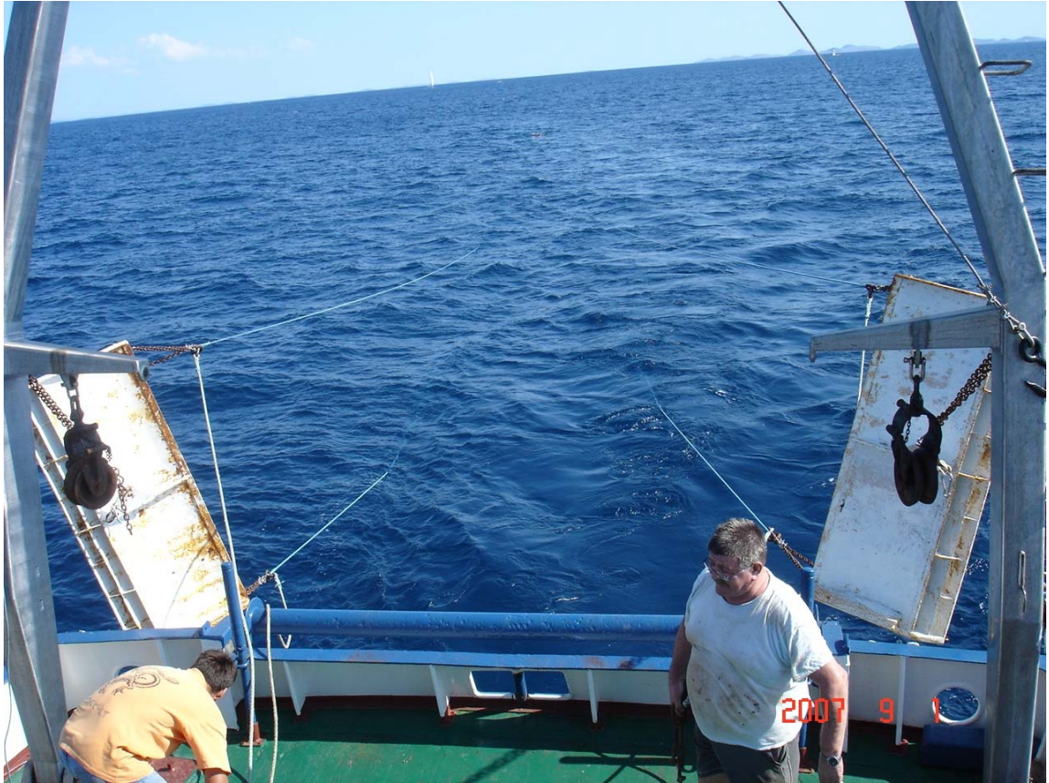
Slika 25. Pelagične širilice upotrebljavane za uzorkovanje pelagičnom kočicom (Foto: D. Bogner).
