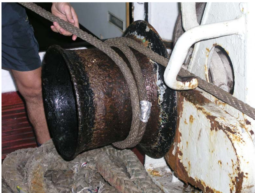
Slika 28. Izvlačenje mreže iz mora pomoću priteznog bubnja (Foto: V.Tičina).
