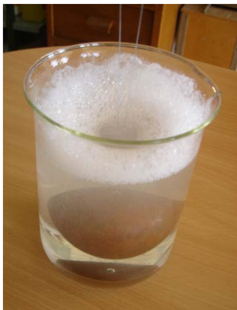
Slika 11. Namakanje bakrene kugle u blagoj otopini deterdženta neposredno prije kalibracije (Foto: V. Tičina).
