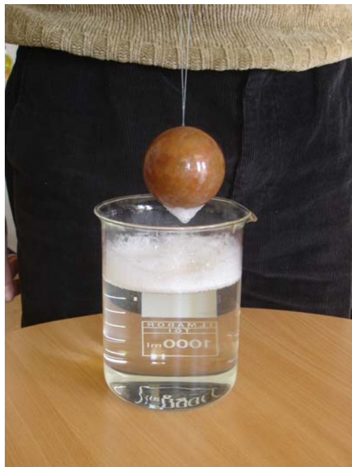
Slika 10. Standardizirana bakrena kugla za kalibraciju pretvarača od 38 kHz.
