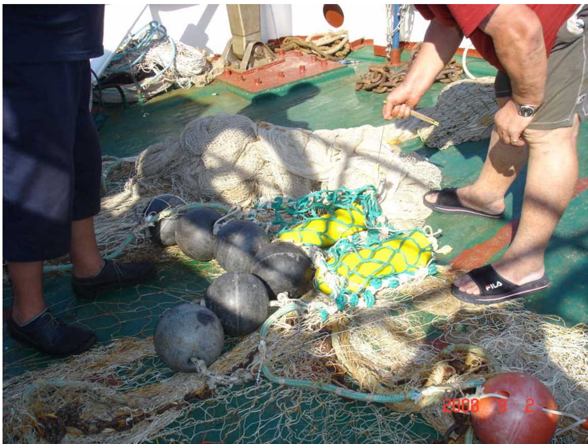
Slika 21. Mrežne sonde (žuto) montirane na plutnji pelagične koće (Foto: V. Tičina).
