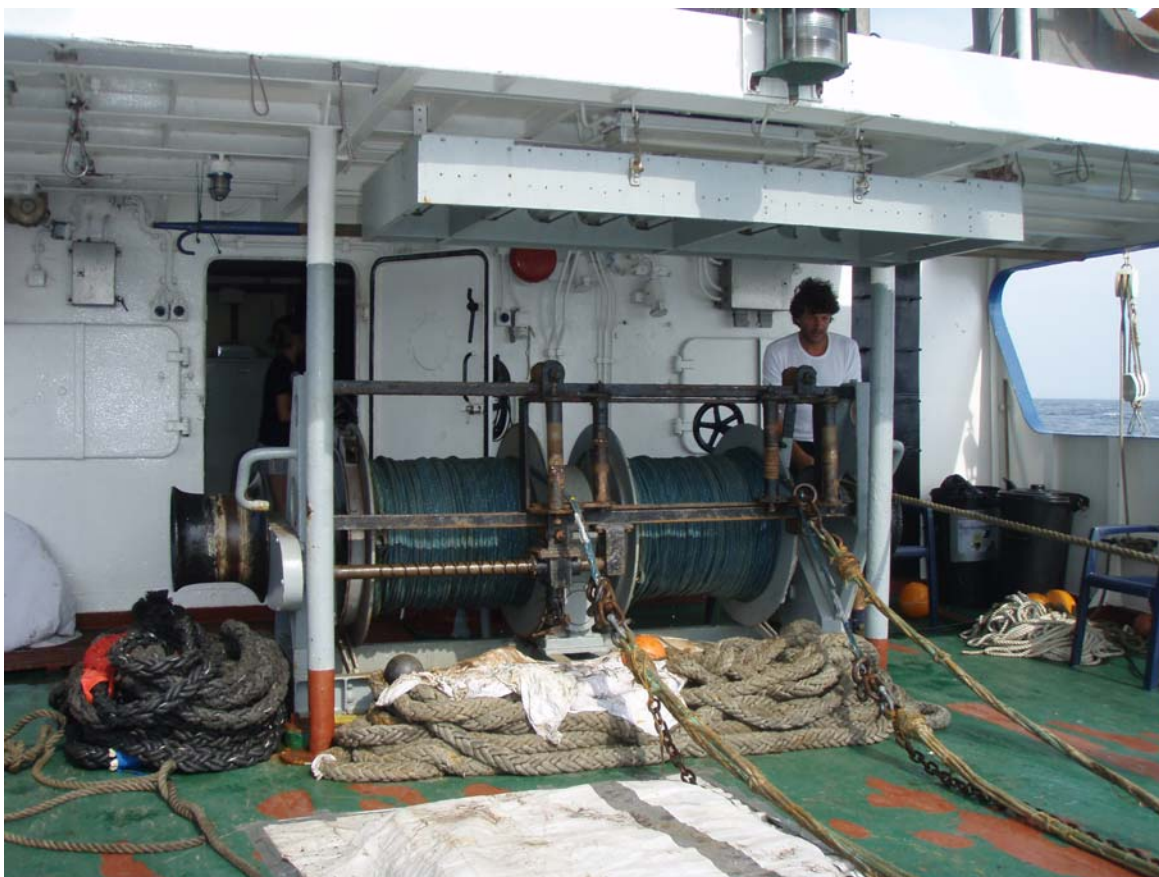
Slika 23. Kočarsko vitlo s dva glavna bubnja za povlačnu užad na MB “Bios” (Foto: T. Šegvić).
