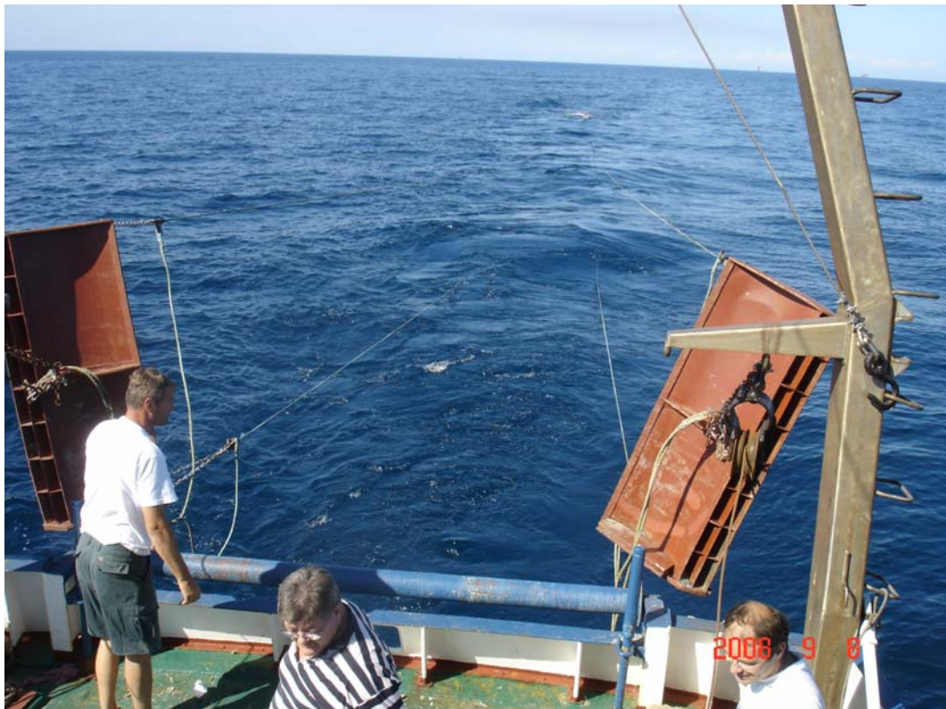
Slika 25. Pelagične širilice upotrebljavane za uzorkovanje pelagičnom koćom (Foto: D. Bogner).
