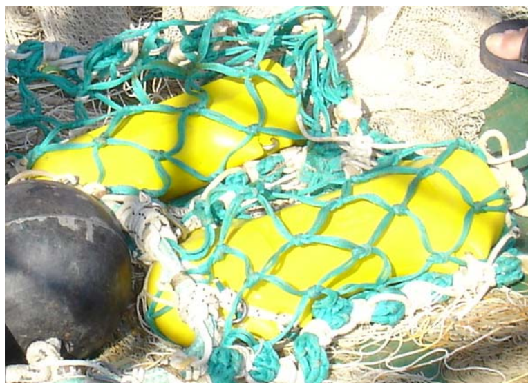
Slika 17. Mrežne sonde (žuto) pričvršćene na plutnji pelagične koće (Foto: V. Tičina).
