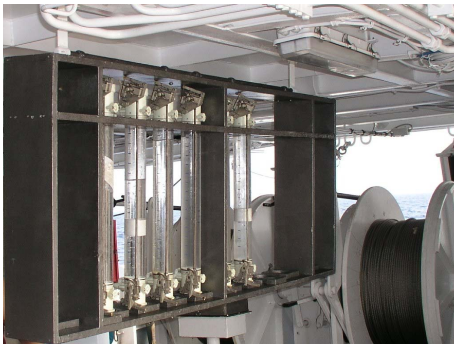
Slika 12. Nansenovi crpci za uzimanje uzoraka morske vode za analizu koncentracije otopljenog kisika i fitoplanktona na brodu BIOS DVA (Foto: V. Tičina).
