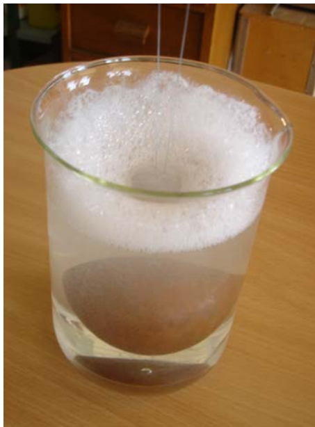
Slika 7. Namakanje bakrene kugle u blagoj otopini deterdženta neposredno prije kalibracije (Foto: V. Tičina).
