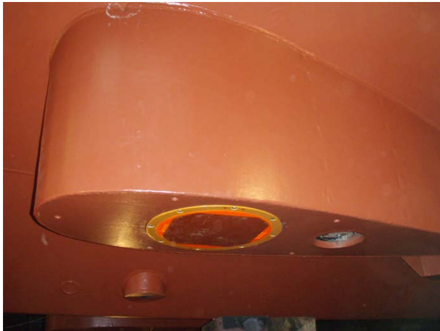
Slika 4. Novi pretvarač SIMRAD ES38B ugrađen na trup novog istraživačkog broda „BIOS DVA“ (Foto: V. Tičina, 2009.)
