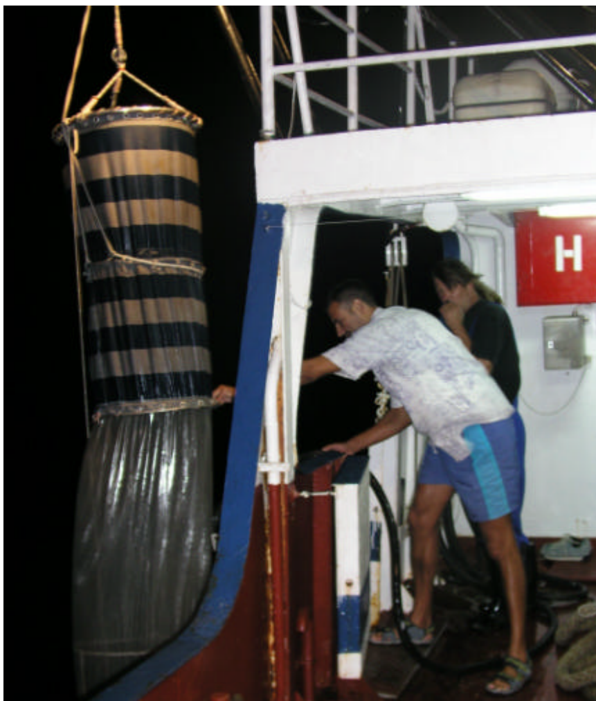
Slika 18. Noćno uzorkovanje zooplanktona Nansen-ovom planktonskom mrežom s mehanizmom za zatvaranje (Foto: V. Ticina).
