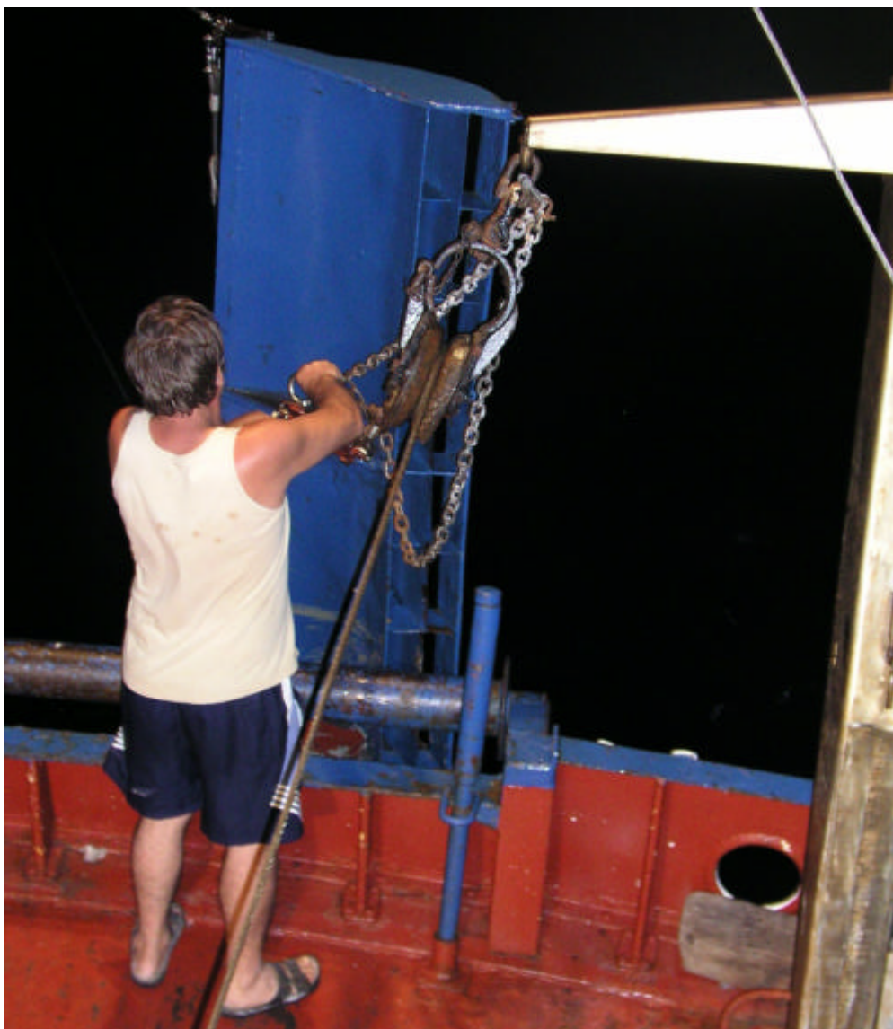
Slika 30. Ucvršćivanje pelagije širlice lancem na kmeni portal (Foto: V. Ticina).
