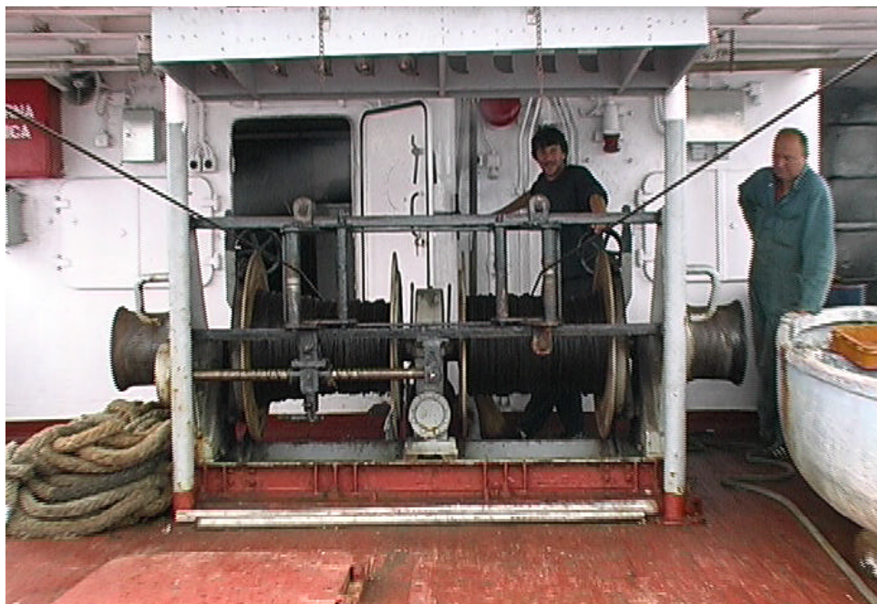
Slika 24. Kocarsko vitlo s dva glavna bubnja za povlacnu užad i dva pomocna pritezna bubnja na MB “Bios” (Foto: A. Soldo).
