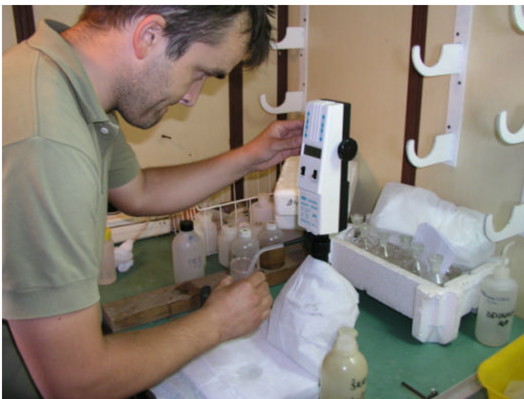
Slika 15. Određivanje sadržaja otopljenog kisika u uzorcima standardnom titracijom s tiosulfatom (Foto: V. Ticina).
