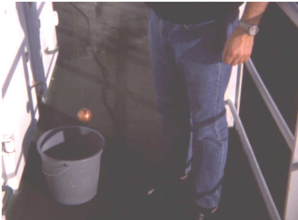
Slika 11. Namakanje bakrene kugle u blagoj otopini deterdženta neposredno prije kalibracije (Foto: V. Ticina).
