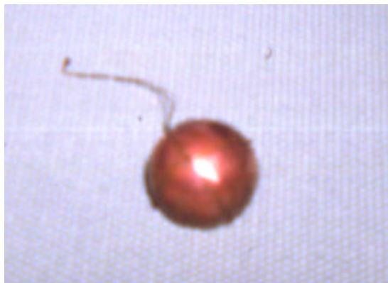
Slika 10. Standardizirana bakrena kugla za kalibraciju pretvaraca od 38 kHz.
