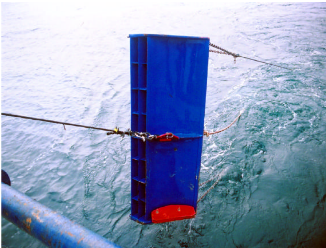
Slika 27. Pelagicna širilica RMP – TD (desna) upotrebljavana u istraživanjima (Foto: A. Soldo).
