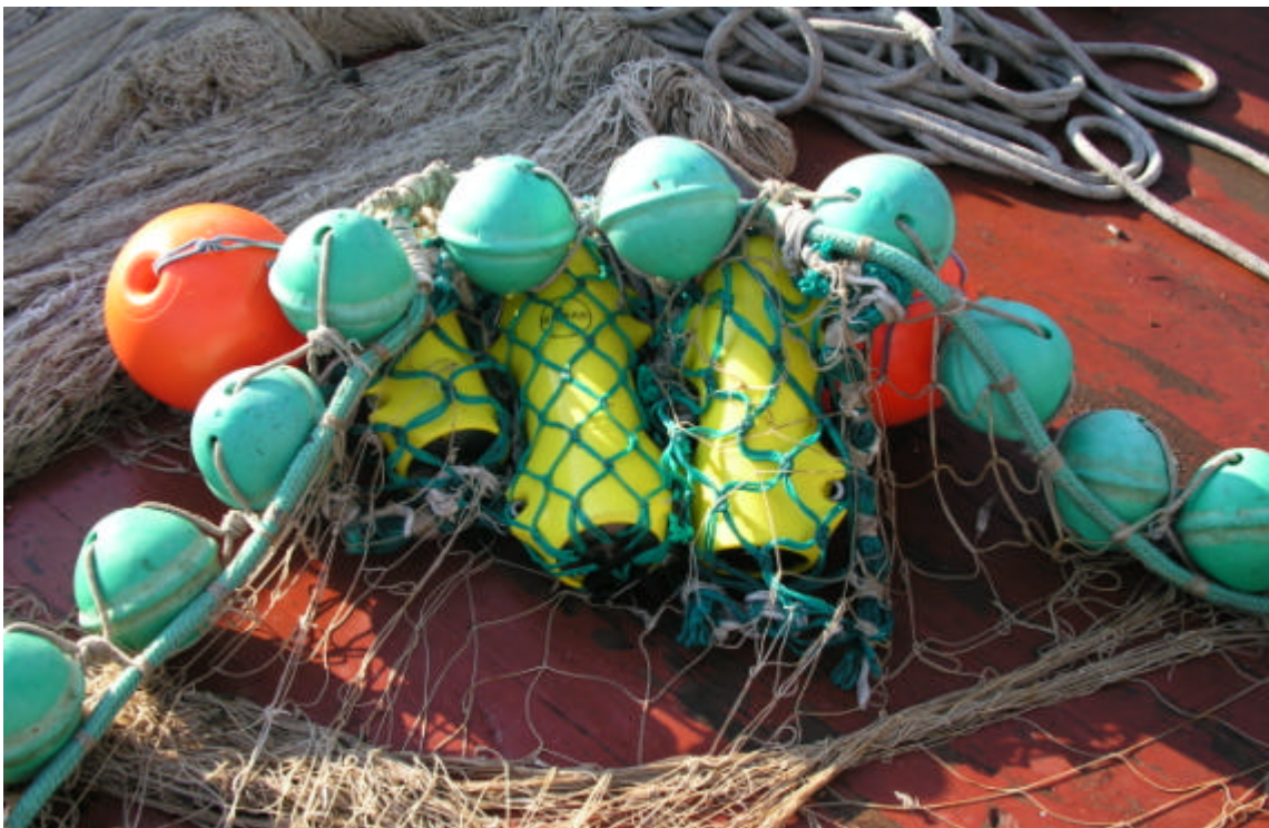
Slika 21. Mrežne sonde (žuto) montirane na plutnji pelagicne koce (Foto: V. Ticina).
