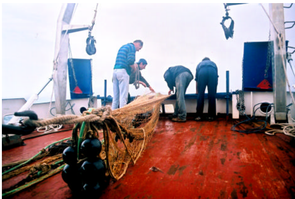
Slika 32. Izvlacenje mreže na krmeni radni dio palube pomocu petlje od konopa, tzv. «imbragavanjem» (Foto: A. Soldo).
