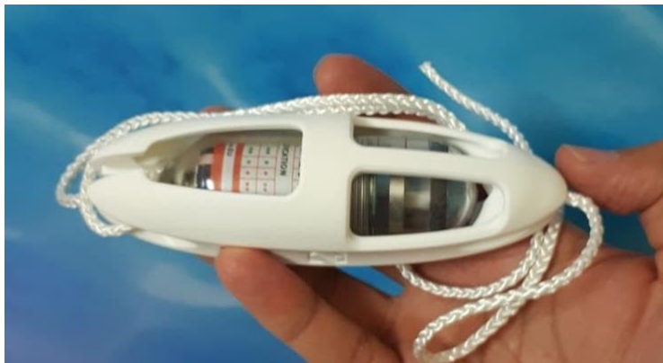
Slika 14. Primjer pingera koji odašilje jače zvukove više frekvencije (Izvor: Blaslov Commerce d.o.o. , Kali)
