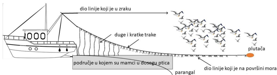
Slika 16. Shematski prilaz plovila s linijom za straženje morskih ptica
