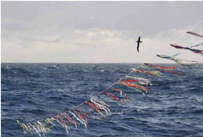
Slika 15. Detalj linije za plašenje morskih ptica (Izvor: https://www.acap.aq/fr/latest-news/3703-bird-scaring-lines-and-night-setting-on-pelagic-longliners-save-albatrosses-from-drowning-on-hooks )
